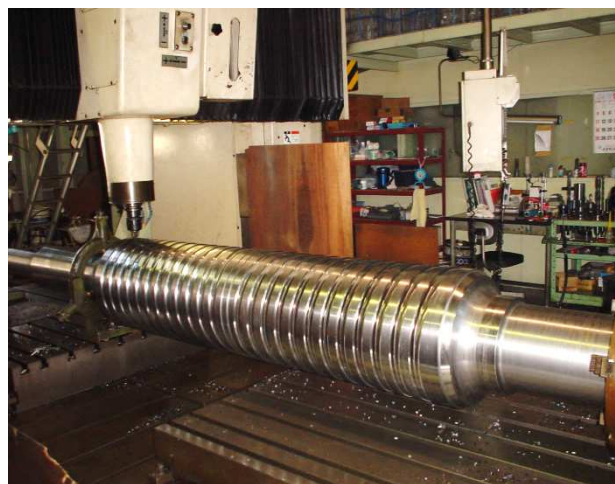
送り溝付ロールシャフト 外径φ270、長さ3300
