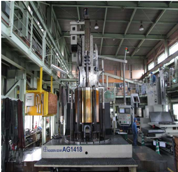
CNC スロッター複合機 AG1418（ストローク 1400）
